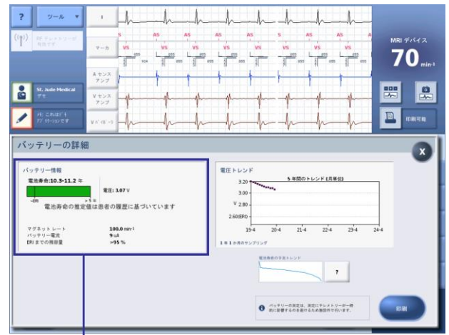
バッテリーの残寿命を予測：電池電圧、マグネットリード、残容量
